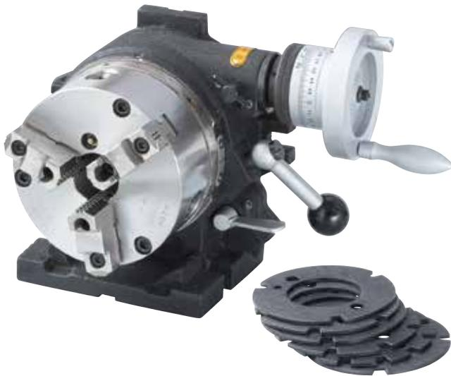
Teilapparat TAHV mit Dreibacken-Drehfutter und sechs präzisen Einrastzscheiben für die Teilungen 2 x 180°, 3 x 120°, 4 x 90°, 6 x 60°, 8 x 45°, 12 x 30° und 24 x 15°
