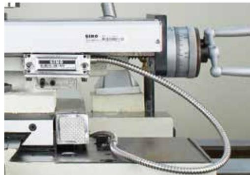
Oberschlitten mit Ableseeinheit auf einer Universaldrehmaschine
