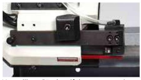
Verstellbare Sägebandführung vorne mit Greifschutz, präzise einstellbarem Spannagerpaar und flexibler Kühlleitung
