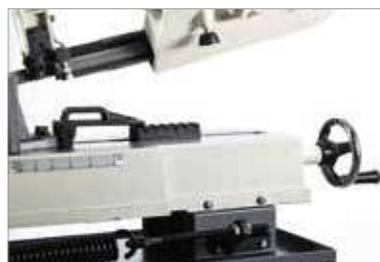
Schnellspannschraubstock mit Distanzhalter und Einstellskala
