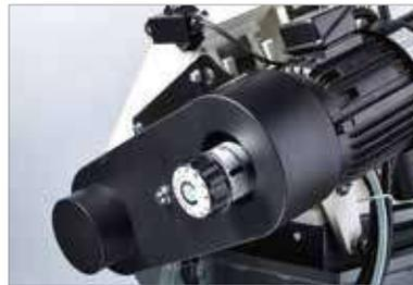
Stufenlos einstellbarer Schnittgeschwindigkeitsregler mit 12 Einstellbereichen 0-11 und Bandgeschwindigkeitsanzeige
