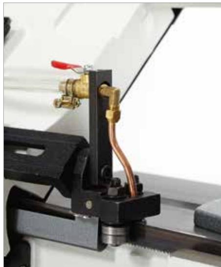
Verstellbarer Spannhalter vorne für enge, sichere Sägebandführung, mit Greifschutz und präzise einstellbarem Spannhalterpaar. Integrierter, flexibler Kühlleitungsanschluss mit Dosier- und Absperrventil
