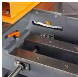
Winkelschnellspanner mit großer, präziser Skala
