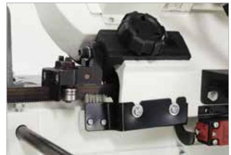
Verstellbarer Spannhalter hinten mit Späneabstreifer, präzise einstellbarem Spannhalterpaar und kräftiger Spänebürste
