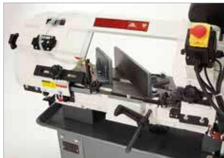
Einfach verstellbare Spannbacken für Schnittwinkel 0-45°, Stangensperre mit verstellbarem Materialanschlag für höchste Wiederholgenauigkeit bei Serienschritt
