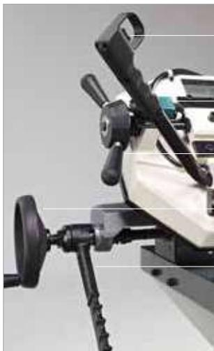
ERGO-Bedienhebel für Manuellbetrieb mit Ein-/Ausschalter
