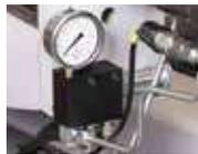
Spanndruckregelung des Spannstockes
