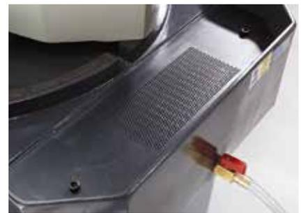
Spänewanne mit Kühlmittelbehälter, Abb. Rücklauffilter und Dosierventil
