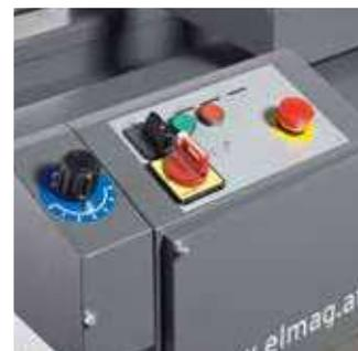
Absenkautomatik - Drehregler am Steuerpult
