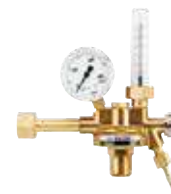
Druckregler mit Flowmeter 5-30 lt./min Argon, CO2, Mischgas Flaschenanschluss W21,8x1/14" SW 30
