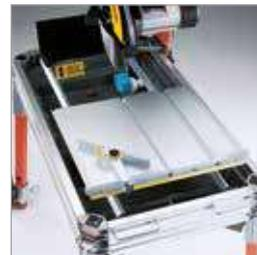
Übersichtliche Messskala, verstellbarer Winkelanschlag und fixierbare Anschlagsschiene des Aluminium-Rolltisches für rasche, präzise Einstellung.
