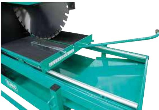
Queranschlag mit Messskala, Handhebel für komfortable Bewegung des Horizontalschlittens
