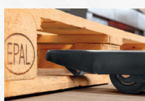
Robuster Anschlagblock an der Gabelspitze
