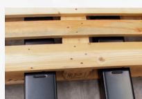
Jelölés a villákon a rakodógép optimális elhelyezéséhez, amikor oldalirányú emelést végeznek egy raklapon.
