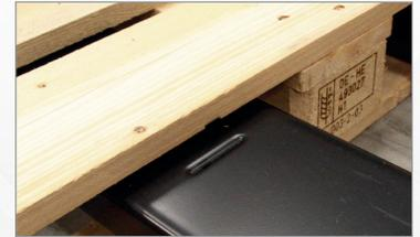
Gelaserte Markierung an Gabeln für optimale Position des Hubwagens bei seitlichem Einfahren in Palette
